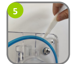
Remove Dispensing Door Gasket
